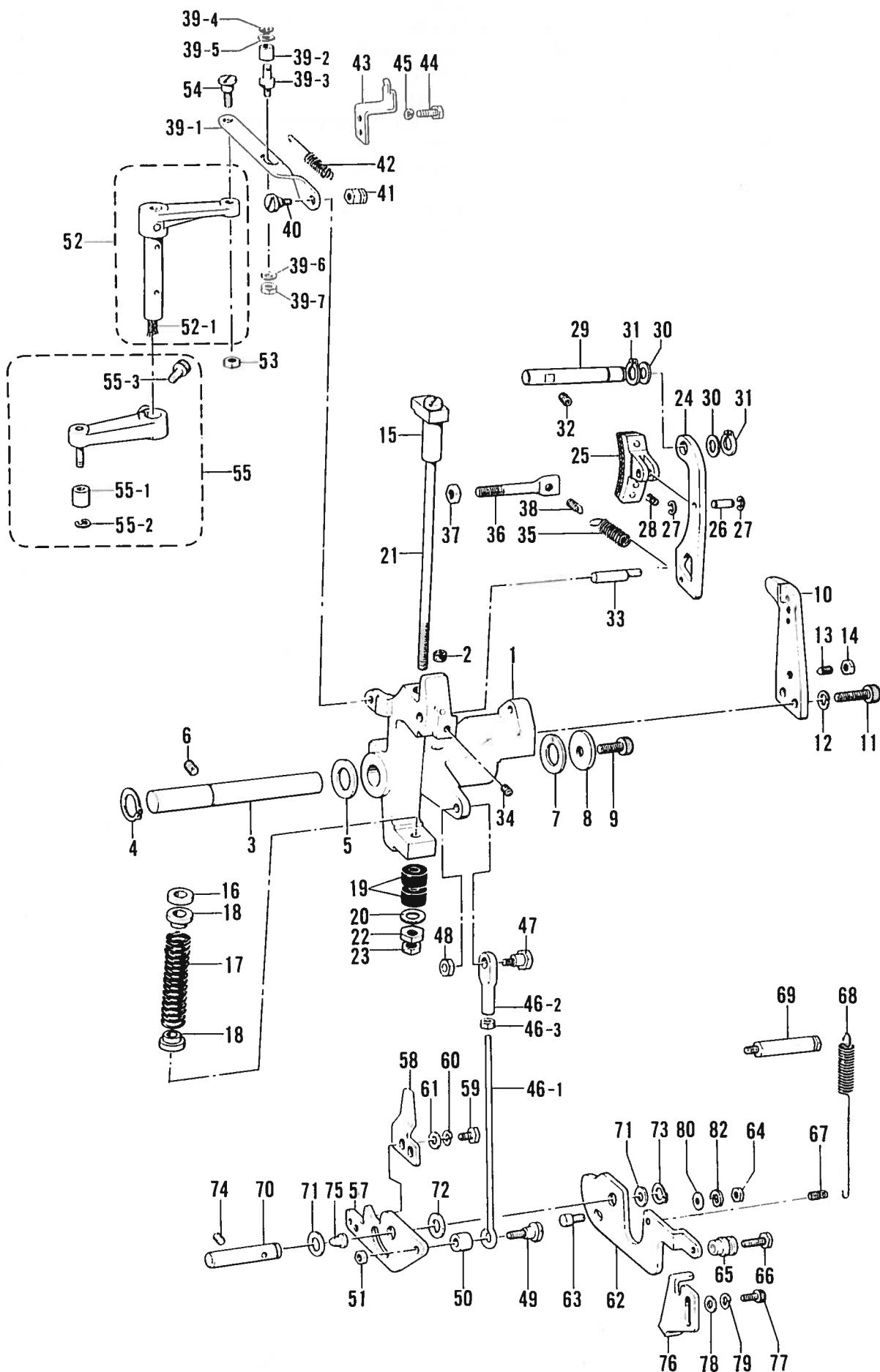
B. クラッチ関係/Clutch mechanism/Kupplungsvorrichtung/
