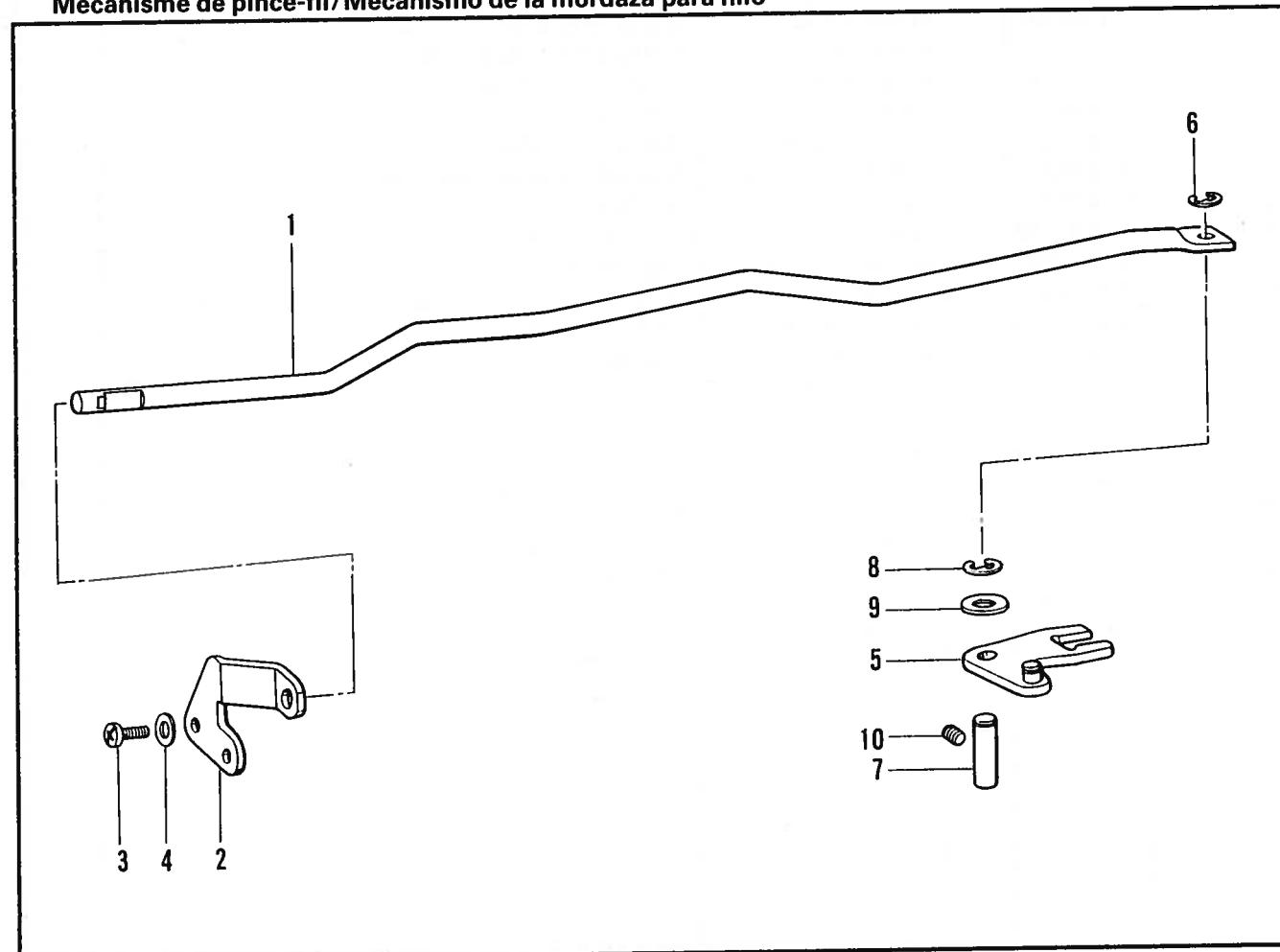
Q. 糸扱イ関係 / Thread wiper mechanism / Fadenwischvorrichtung /
