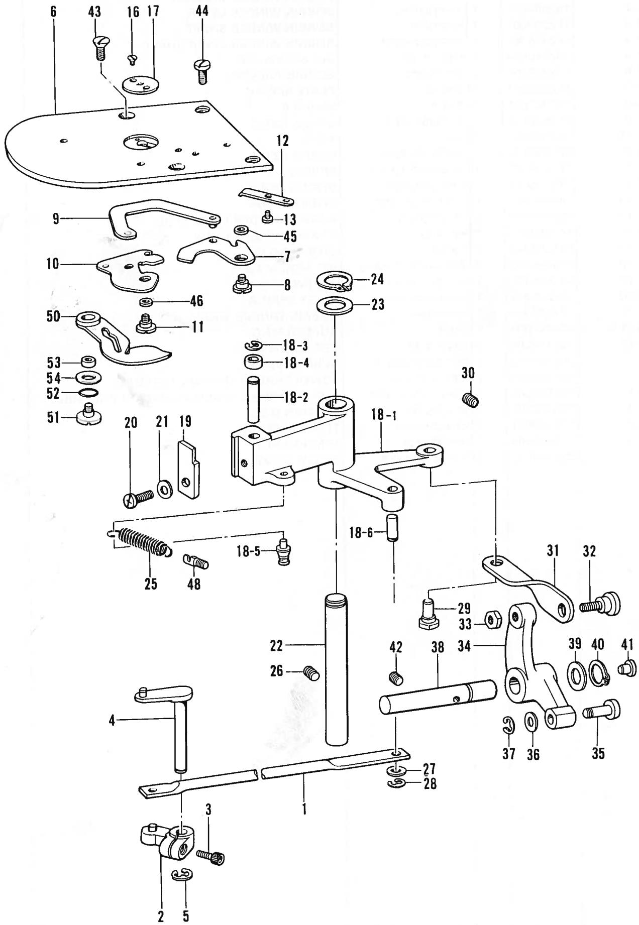
P. 糸切り関係 / Thread trimmer mechanism / Fadenabschneidevorrichtung /
