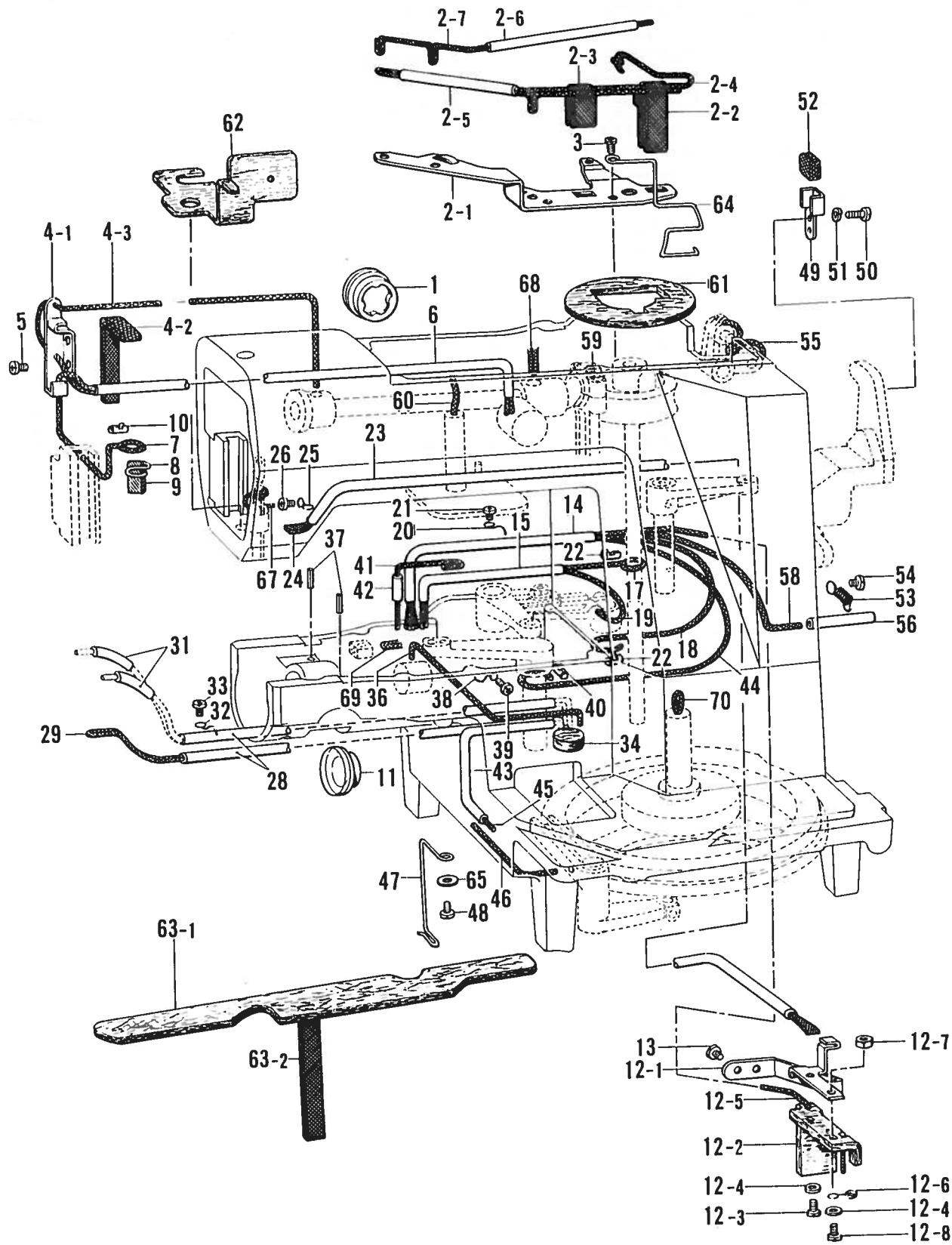
L. 給油潤滑関係/Lubrication/Schmierung/Lubrification/Lubricación
