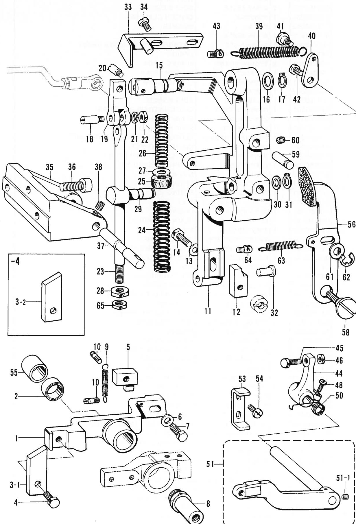
E. 停止関係 / Clutch mechanism/Kupplungsvorrichtung/
