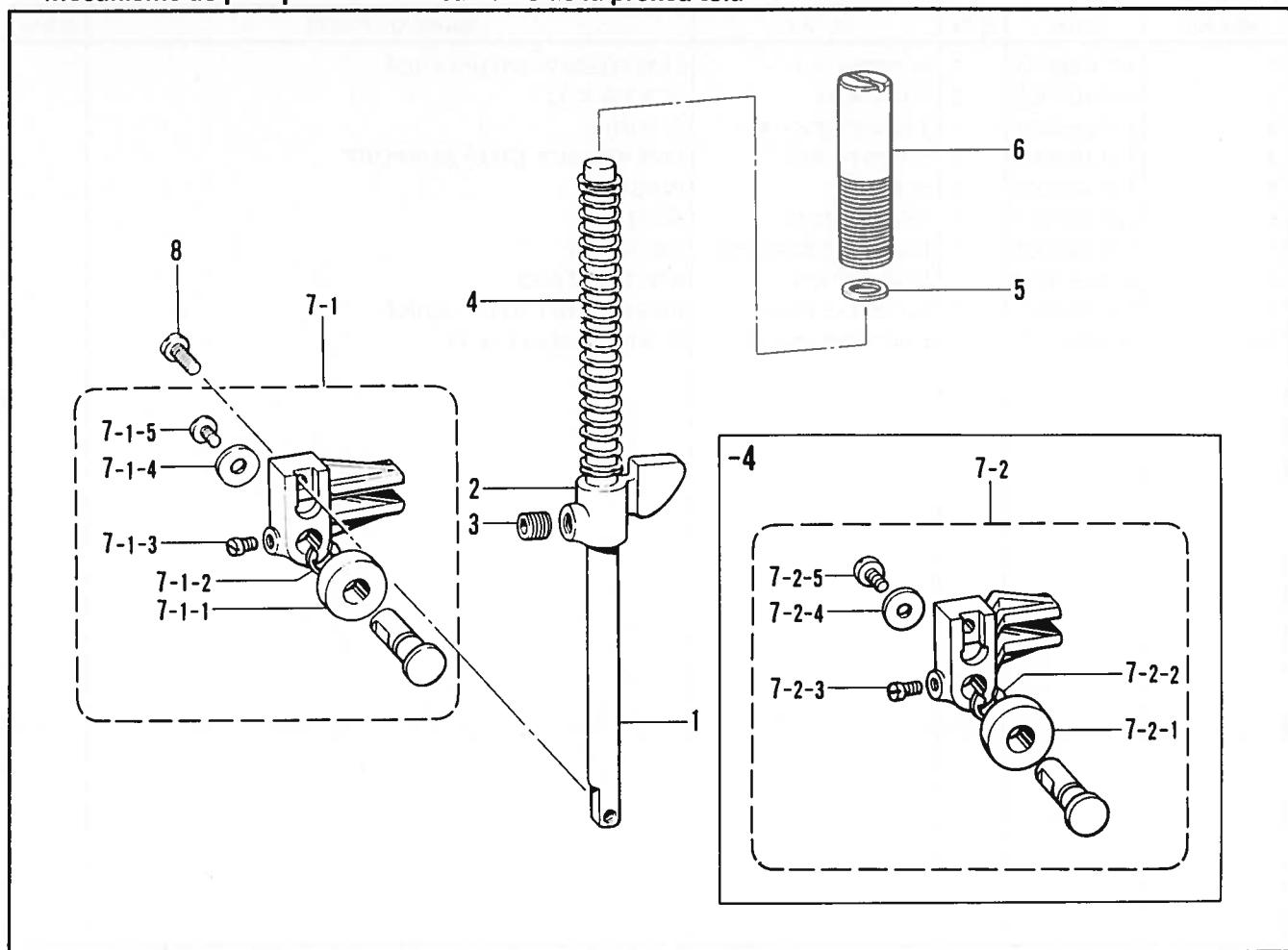
K. 押工関係 /Presser foot mechanism/Stoffdrückerfuß/
