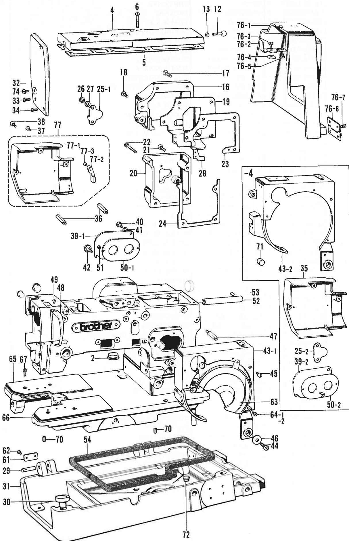
A. 主体関係 / Machine body/Maschinengehäuse/
