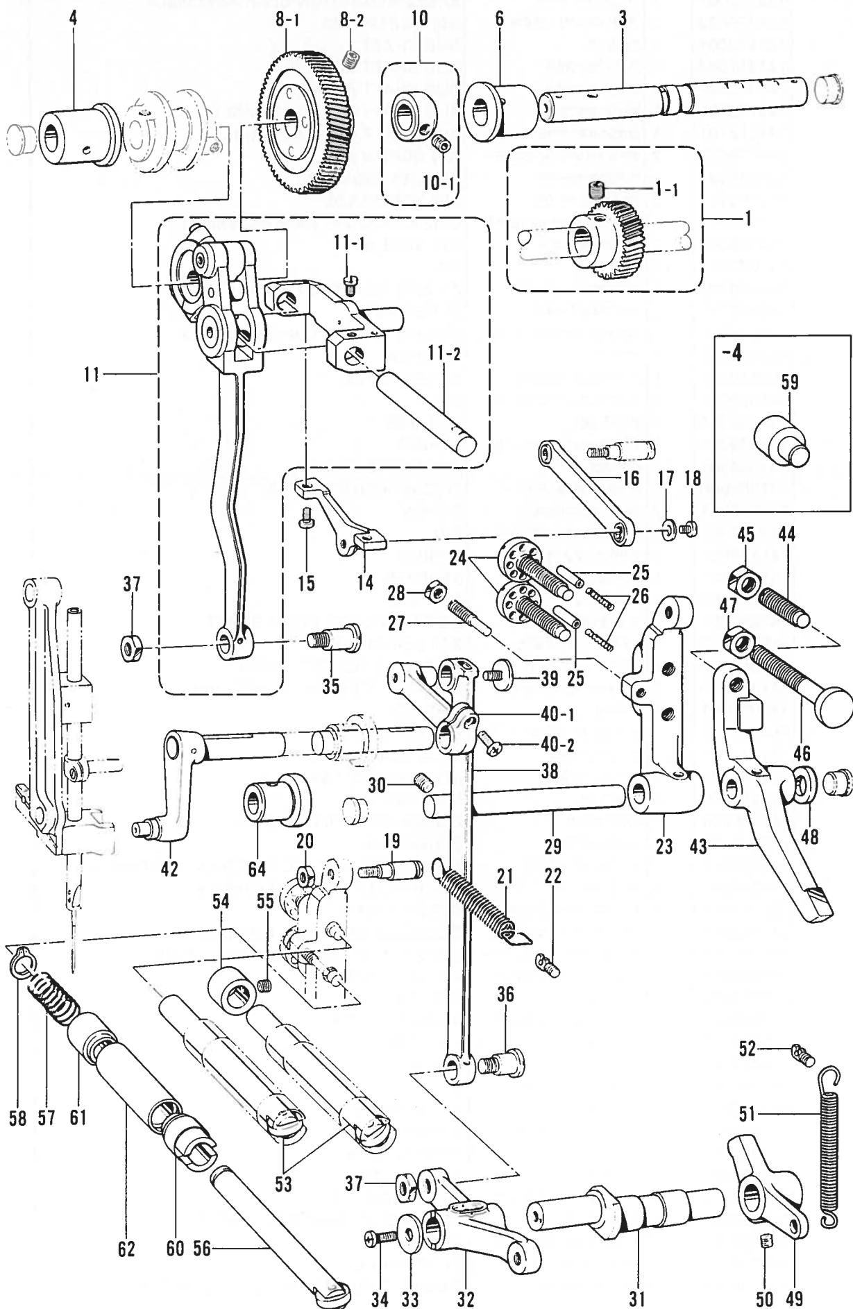
D. 針振関係 /Zigzag mechanism/Zickzackvorrichtung/
